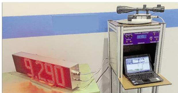
Technischer Clou der Anlage in Stollhamm ist die elektronische Weitenmessung.
